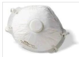
Descripción RPMS1804: FFP2 contra polvo de baja toxicidad. Protección nominal: 12xTLV Con válvula de exhalación para facilitar la expulsión de aire y minimizar la retención de calor y humedad en el interior. Clip nasal, doble goma de sujeción, reborde
