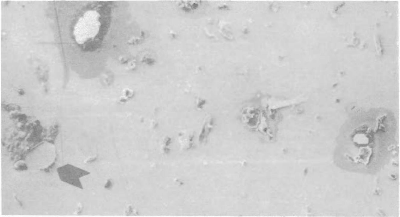
Figura VIII(A)-35. Mismo ejemplo de corrosión en un poro, como el que se presenta en la figura 34 (amplificación 160x). La flecha indica la misma erupción que se presenta en la figura 34.
