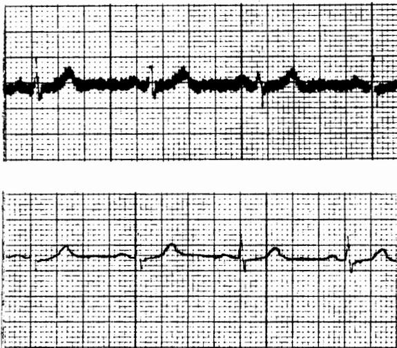
**Figura V(C)-8.** Registros ECG en derivación II. Trazo superior, pierna derecha con mal contacto a tierra e incremento de la corriente de desplazamiento. Trazo inferior, tórax a tierra. Nótese que no hay cambio en la forma de las ondas del ECG, pero disminuye la interferencia.
