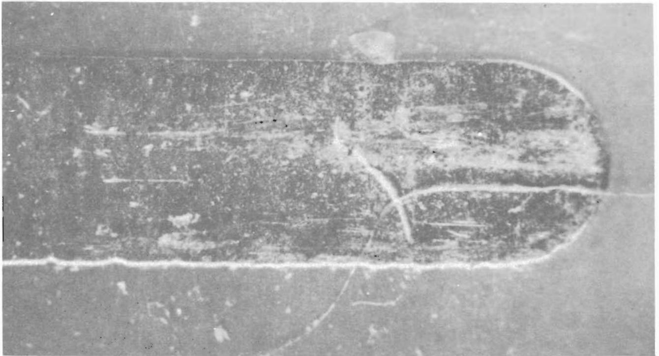
**Figura VIII(A)-33.** Ejemplo de un conector de borde sucio. Note las fibras machacadas y la peluza de un hisopo de algodón y de la tela tipo papel.
