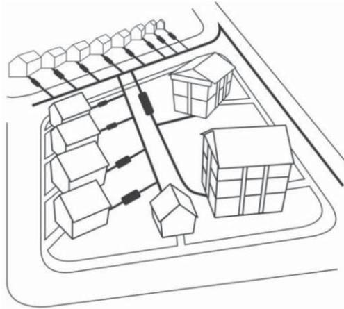
En el sistema de alcantarillado de pequeño diámetro, las aguas residuales son previamente sedimentadas en un tanque séptico unifamiliar, instalado a la salida de la caja de registro. La descarga del tanque se conecta a la red de alcantarillado, que tiene un diámetro mínimo de 100 mm. Como se efectúa la remoción de sólidos previamente a la descarga a la red de alcantarillado, los requerimientos de mantenimiento se reducen significativamente en la red.
