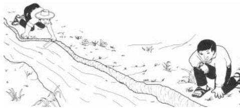
inicia la toma del tiempo que dura el viaje hasta el punto de control corriente abajo. Al resultado de la velocidad se le ajusta por un factor de 0.8 a 0.9
