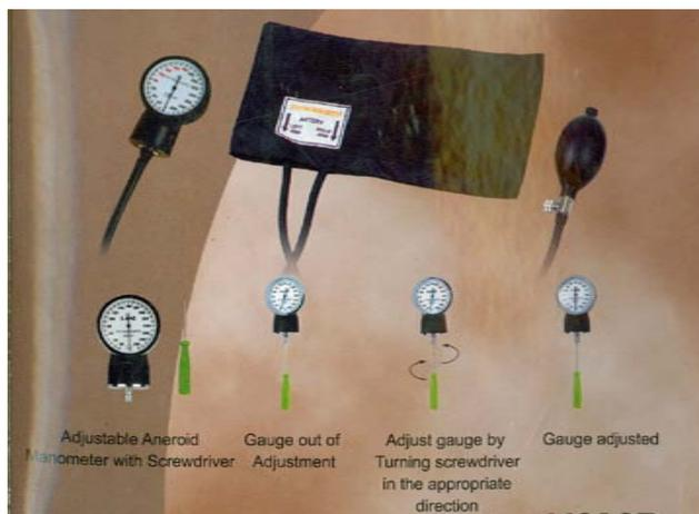
En caso de que la calibración sugerida no arregle el problema se sugiere sustituir el manómetro, el cual puede adquirir en el punto de venta ubicado en su estado.
