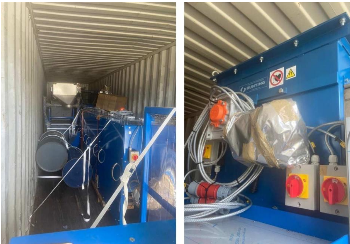
Figura 19. Planta de tratamiento de residuos con mercurio (previo a su instalación)
