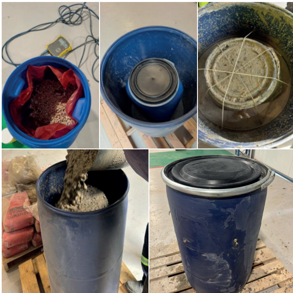
ILUSTRACIÓN 16. Neutralización y macroencapsulado de los residuos con mercurio.
